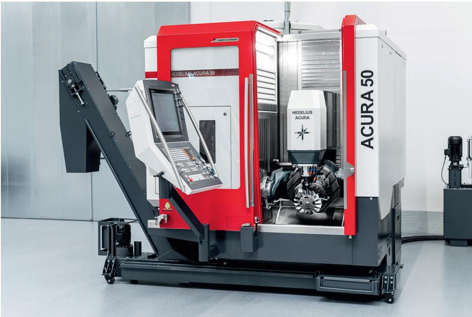
1 Superkompakt und hochpräzise: 5-Achs-Bearbeitungszentren 'Acura 50' mit beidseitig gelagertem Dreh-Schwenktisch © Hedelius
